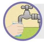
Feche o registro, abra uma torneira alimentada diretamente pela concessionária (pode ser a do jardim) e espere a água parar de sair. Coloque um copo cheio de água na boca da torneira. Caso haja sucção da água do copo é sinal de que há vazamento no ramal interno.
